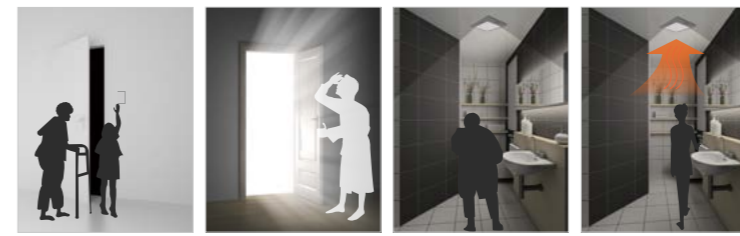
노약자의 스위치 조작 어려움 해소 / 야간 욕실 이용 시 조도센서로 눈부심 방지 / 지능형 센서로 사용자 편리성 향상 / 자동습도 조절로 쾌적한 욕실 유지
