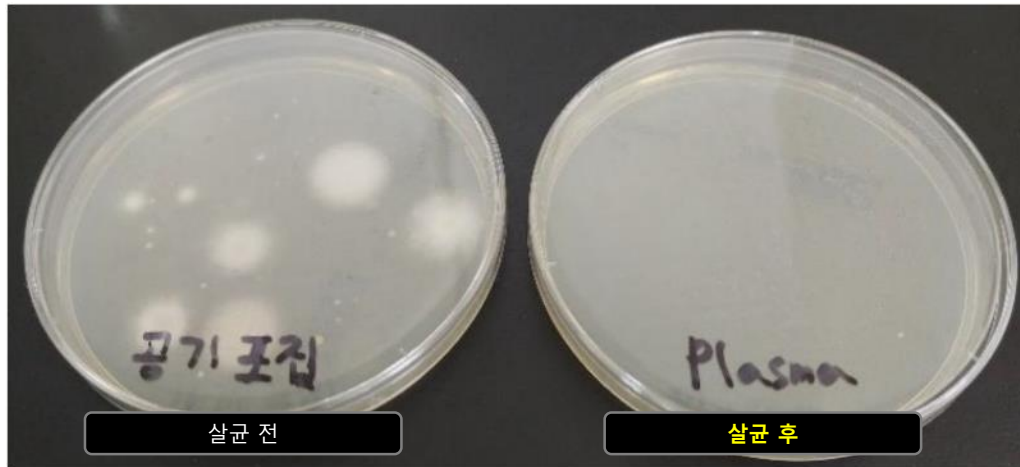
48시간 후 공기 포집 PCA 상태 (좌), 플라즈마 살균 후 PCA 상태 (우)
